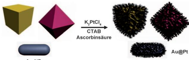
**Auf die inneren Werte kommt es an:** Die katalytische Aktivität von Au@Pt-Heteronanostrukturen (siehe Schema; CTAB: Cetyltrimethylammoniumbromid, NPs: Nanopartikel) für die Sauerstoffreduktion
