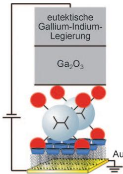
**Die Enden entscheiden:** Das Ausmaß der Stromgleichrichtung an definierten supramolekularen Tunnelübergängen lässt sich über die Endgruppen (rote Kugeln) von Dendrimeren (graue Kugeln) einstellen, die auf einem supramolekularen Substrat immobilisiert sind (siehe Bild). Biferrocen- und Ferrocen-Endgruppen ergaben ein größeres Gleichrichtungsverhältnis als Adamantyl-Endgruppen.
