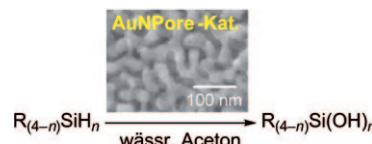
**Goldene Aussichten:** Nanoporöses Gold (AuNPore) zeigt eine bemerkenswerte katalytische Aktivität für die Oxidation von Organosilanen mit Wasser. Der Katalysator lässt sich leicht zurückgewinnen und wiederholt verwenden, ohne dass Verluste durch Auflösung oder Aktivitätseinbußen auftreten.
