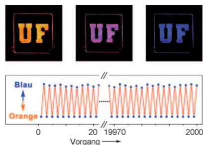
**Farbenpalette:** Mangan-dotierte Halbleiter-Nanokristalle gehen Doppellemissionen in Abhängigkeit von der Anregungsintensität ein. Die Emissionsfarbe der dotierten Nanokristalle kann unter monochromatischen Bedingungen über die Anregungsfluenz von Orange nach Blau abgestimmt werden. Die Farbabstimmung ist reversibel und geht auf die Anregung multipler Mn-Dotanten innerhalb des Nanokristalls zurück.
