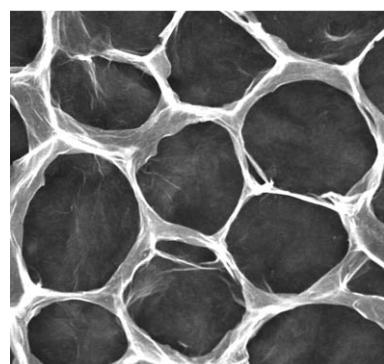
**Graphenoxid-Plättchen** können sich zu hoch geordneten und flexiblen Kohlenstoff-Filmen mit einstellbaren Porenmorphologien organisieren. Durch Dotieren mit Stickstoff werden die elektrischen Eigenschaften und Superkondensator-Charakteristika der kohlenstoffbasierten Strukturen verbessert, und eine chemische Funktionalisierung wird ermöglicht.
