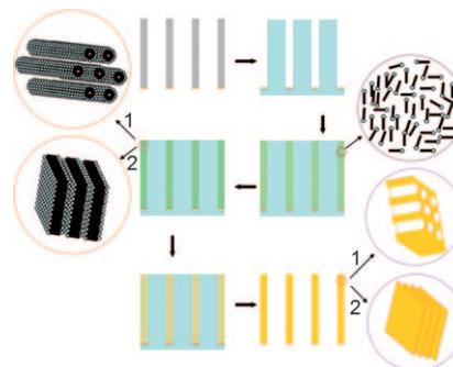
**Durchlöchert oder nicht?** In einem zweistufigen Verfahren gelingt die Synthese der Titelmembranen mit geordneten Mesoporen und einstellbaren Makroporenkanälen aus lytropen Flüssigkristallen mit Polymethylmethacrylat-Templaten. Die Mesosstruktur der Membranen lässt sich über die Konzentration der Tensidlösung maßschneidern (siehe Bild: 1 = niedrige, 2 = hohe Konzentration).
